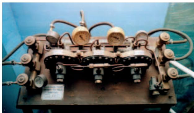
Fig. 141 - Il "gruppo di decompressione e regolazione" dei gas per il cannello da taglio facente parte del diorama del Museo Nazionale delle Attività Subacquee di Marina di Ravenna (g.c. HDS Italia).
