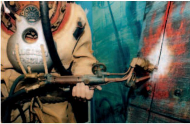
Fig. 142 - Particolare del cannello da taglio modello P.H.7 della SIO del diorama del Museo Nazionale delle Attività Subacquee di Marina di Ravenna (g.c. HDS Italia).
