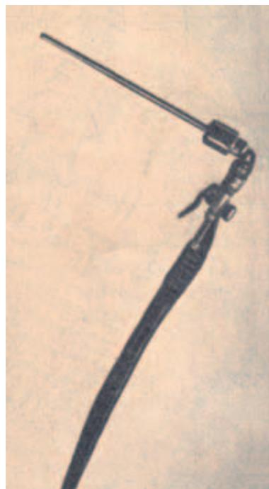
La pinza da taglio ossi-elettrico subacqueo è ora prodotta da diverse ditte e universalmente utilizzata. Funziona con l'impiego di elettrodi cavi, siano essi di carbone, di ferro o ultratermici,
